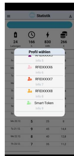
Bei der Anmeldung als Operator ist das Starten und Stoppen von Ladevorgängen ohne RFID-Tag (Tag an Wallbox anlegen) zuerst nur möglich, wenn die Wallbox mit der easyCharging-App oder dem Web-Interface für „freies Laden“ konfiguriert wurde.
