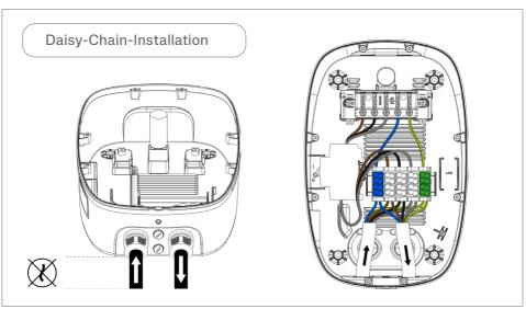
Hinweis: Stellen Sie sicher, dass die Kabel nach der Kabelverschraubung gerade verlaufen, um eine Belastung der Kabelverschraubungen und Kunststoffteile zu vermeiden. Wichtig! Nicht genutzte Kabelöffnungen sind mit geeigneten Blindstopfen aus dem Zubehör-Kit abzudichten.
