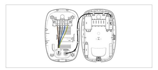
2. Entfernen Sie die Gummitülle vom LAN-Modul.
