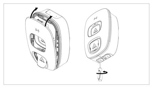
Hinweis: Die Sicherungsschraube der Frontabdeckung sollte nicht entfernt werden. Ziehen Sie die Schraube mit max. 2 Nm an.
