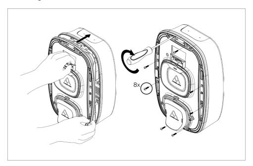
Setzen Sie den Bodenflansch der Frontabdeckung ein und drehen Sie die Abdeckung an die richtige Position. Sichern Sie die Abdeckung anschließend mit der Sicherungsschraube (Torx 25).
