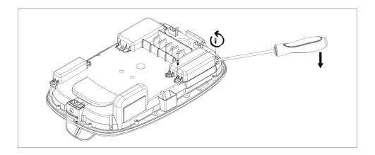
2. Montieren Sie das LAN-Modul und schrauben Sie es fest. Bringen Sie die Kabelklemmen mithilfe der mitgelieferten Schrauben an.
